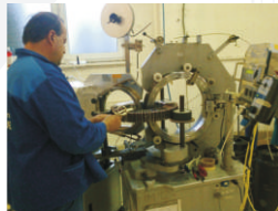
Малый сердечник Гол. для нам. ленты VC44/BU2L Гол. для нам. пр. VC45-V
