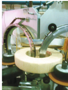
Гол. для нам. ленты VC45/BL с магазином Гол. для нам. пр. VC45-V
