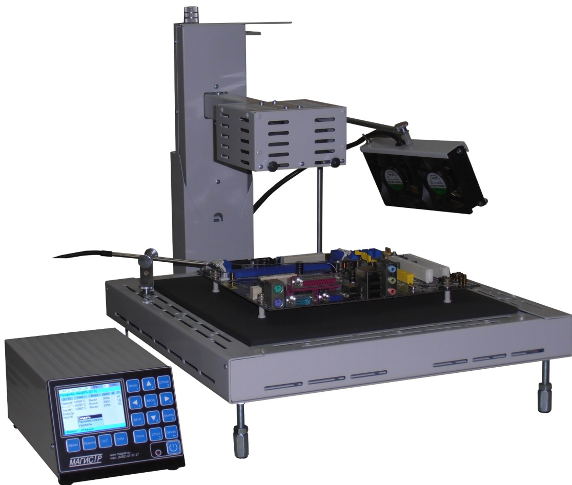
Фото 2. Общий вид станции с нижним термостолом
